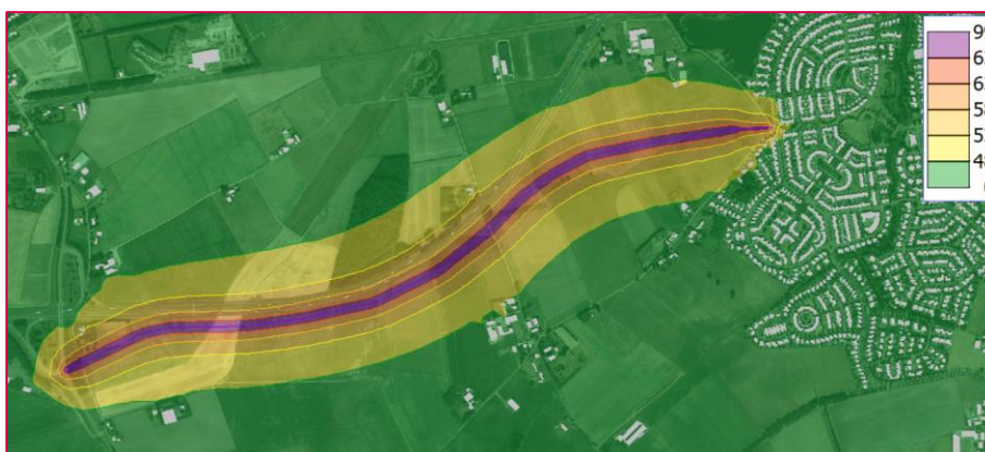
Figuur 6.11: Geluidscontouren t.g.v. nieuwe wegen variant 1b (waarneemhoogte 4,5 m, inclusief correctie artikel 110g Wgh).
