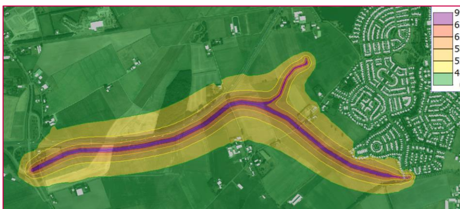
Figuur 6.15: Geluidscontouren t.g.v. nieuwe wegen variant 2b (waarneemhoogte 4,5 m, inclusief correctie artikel 110g Wgh).
