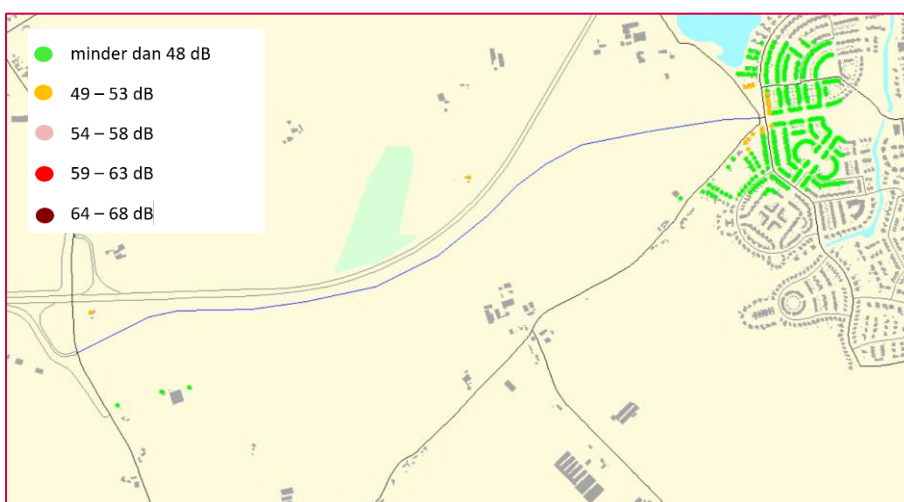
Figuur 6.10: Geluidsbelastingen t.g.v. nieuwe wegen variant 1a (waarneemhoogte 4,5 m, inclusief correctie artikel 110g Wgh).
