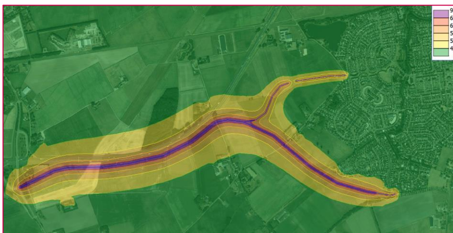
Figuur 6.17: Geluidscontouren t.g.v. nieuwe wegen variant 3a (waarneemhoogte 4,5 m, inclusief correctie artikel 110g Wgh).
