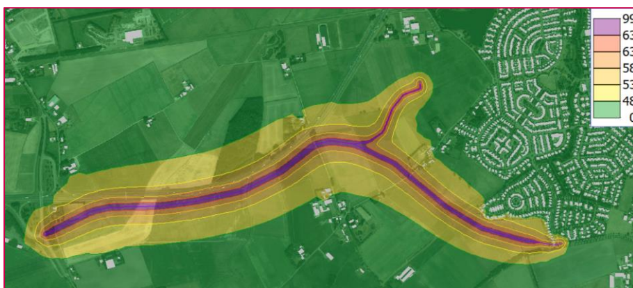
Figuur 6.13: Geluidscontouren t.g.v. nieuwe wegen variant 2a (waarneemhoogte 4,5 m, inclusief correctie artikel 110g Wgh).
