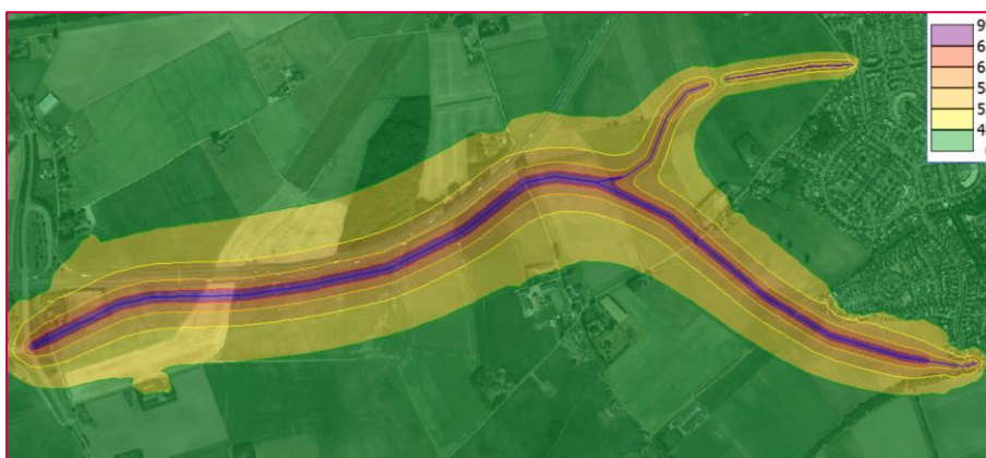
Figuur 6.19: Geluidscontouren t.g.v. nieuwe wegen variant 3b (waarneemhoogte 4,5 m, inclusief correctie artikel 110g Wgh).
