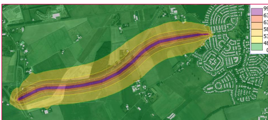
Figuur 6.9: Geluidscontouren t.g.v. nieuwe wegen variant 1a (waarneemhoogte 4,5 m, inclusief correctie artikel 110g Wgh).
